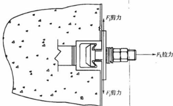
图8 隧道内接触网槽道承载模式图
