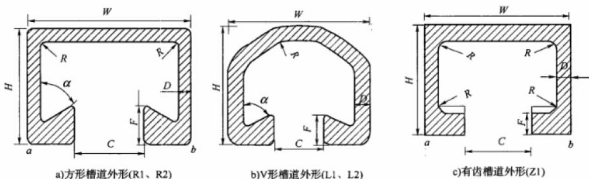
图 1 槽道外形及尺寸示意图
